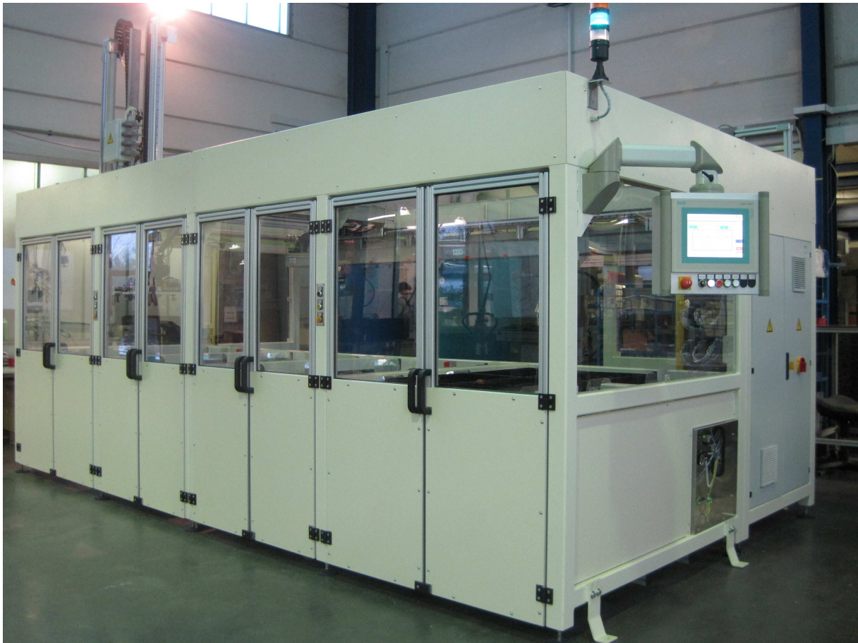
Abb.: Portalroboter EURO-Line in Ausführung als Vierpalettenplatzsystem
